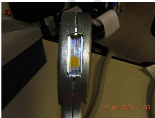
Fotos 54 a 57 – Vista cabo de aplicação, este apresenta danos por queda.
