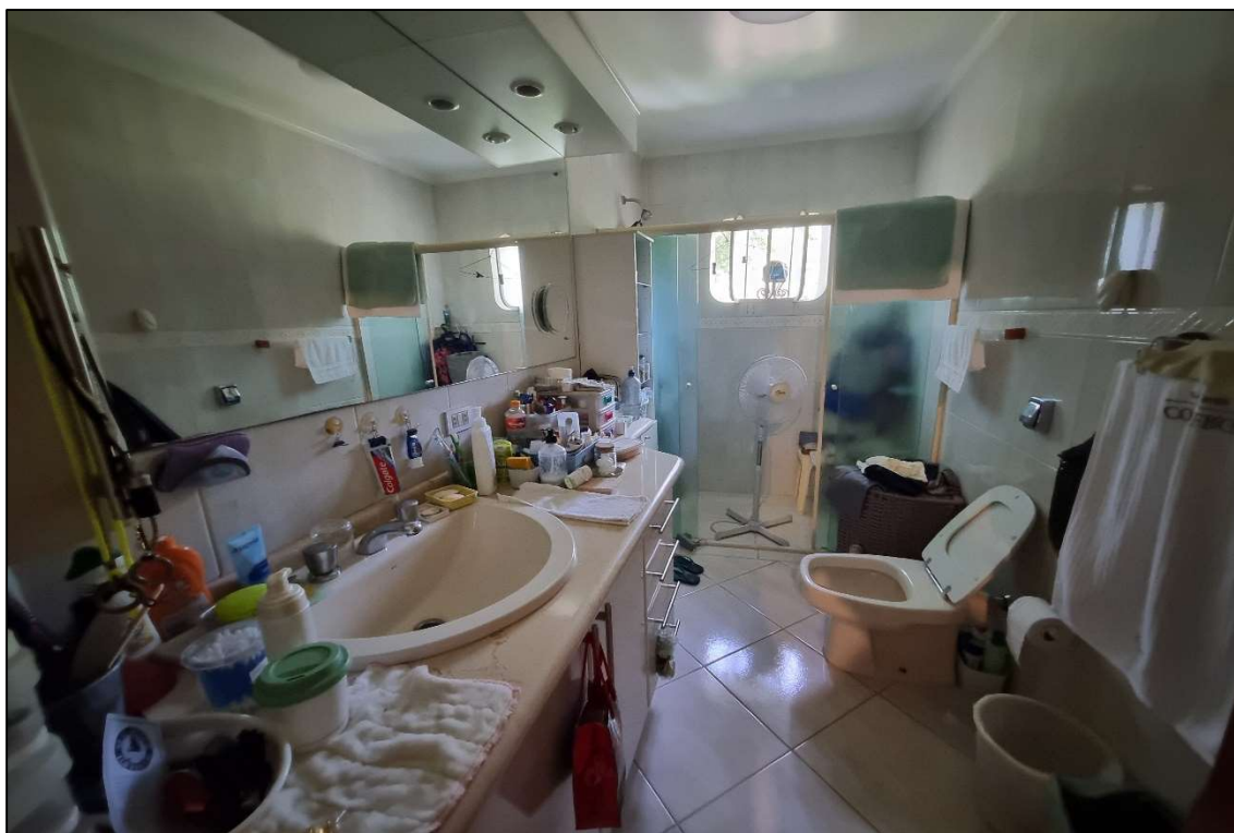
Foto nº 11: Vista de um banheiro no pavimento superior da edificação. Suas principais características construtivas são: piso cerâmico, paredes azulejadas até o teto, forro em laje e esquadrias de madeira.
