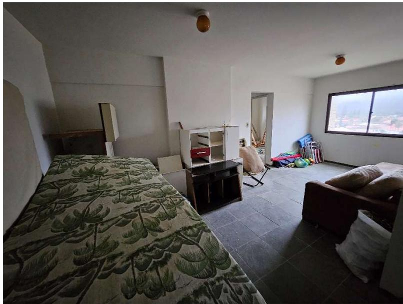
**Foto 13** – Outra vista da sala do apartamento nº 42, imóvel avaliando, apresentando os seguintes padrões construtivos: Piso de ardósia, paredes e teto revestidos em pintura látex PVA sobre massa corrida; porta em madeira e esquadrias em alumínio.
