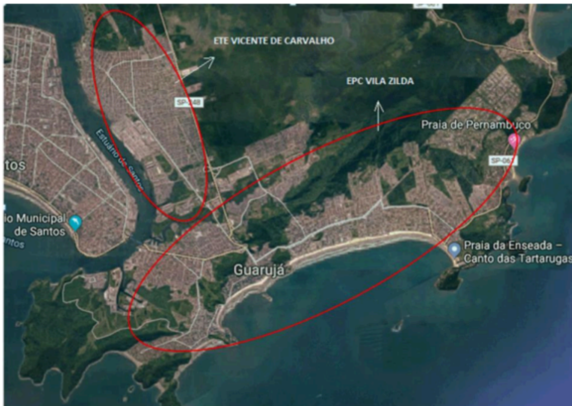
Figura 7 – Bacias de esgotamento no Município de Guarujá
