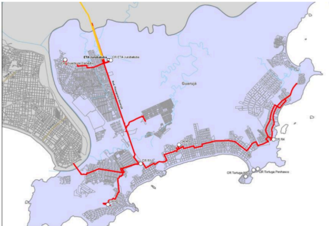
Figura 3 – Sistema de Abastecimento de Água do Guarujá
