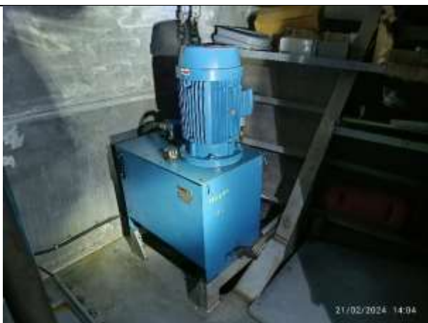
81. Unidade hidráulica do guincho
