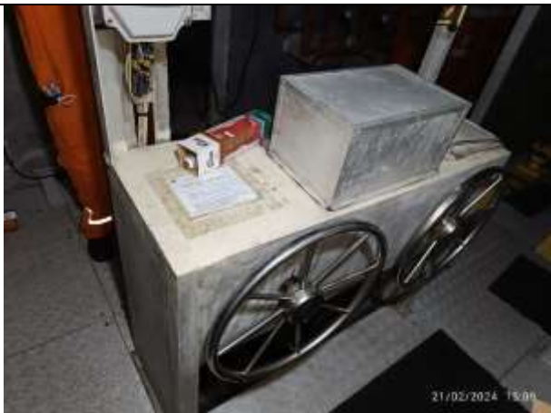
125. Console de comando dos MCPs e lemes no compartimento da máquina dos azimutais
