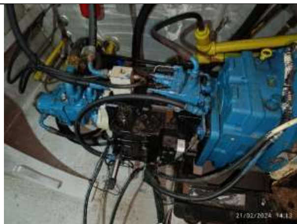
98. Bomba hidráulica do propulsor azimutal
