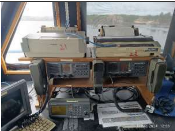
45. Impressoras do telex e do Inmarsat em cima, 2 rádios VHF ao centro e 1 SSB embaixo
