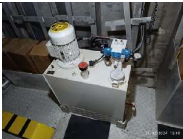
122. Unidade hidráulica da máquina do leme de boreste
