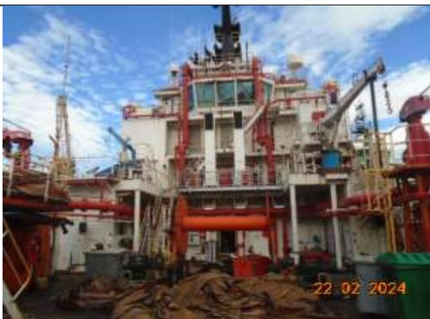
15. Pintura desgastada e pontos de corrosão na superestrutura por ré
