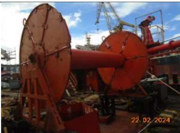
17. Pontos de corrosão no Carretel auxiliar de barreira de contenção e equipamento de acionamento removido
