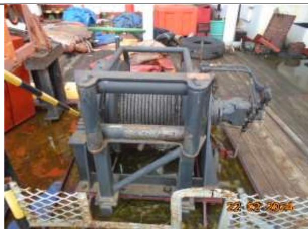
16. Pintura desgastada e pontos de corrosão no guincho auxiliar de convés
