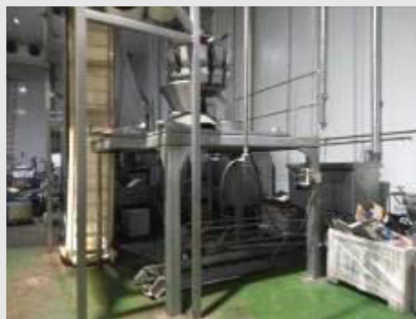
BALANÇA DOSADORA DE CARNE EM AÇO INOX MARCA ISHIDA, C/ PAINEL ELETRÔNICO DIGITAL | Item: 32 |
