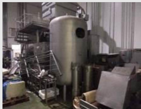
FILTRO DE CARVÃO ATIVADO EM AÇO INOX 304 MARCA TECH FILTER, MOD. TFCCI 30000 7TC S120-4, VOL. 4.190 L, N.S. TF832 | Item: 93 |
