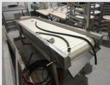
ESTEIRA TRANSPORTADORA C/ ESTRUTURA EM AÇO INOX, DIM. 600X2.400 MM (S/ MOTOR) | Item: 51 |
