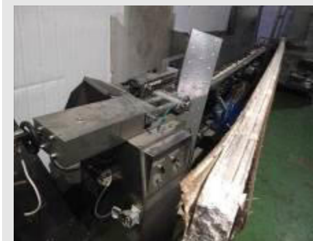
LINHA DE DOSAGEM DE MOLHO P/ LASANHA, COMPOSTO 4 DOSADORES MARCA GS, ESTEIRA DE TALISCA E SELADORA | Item: 90 |
