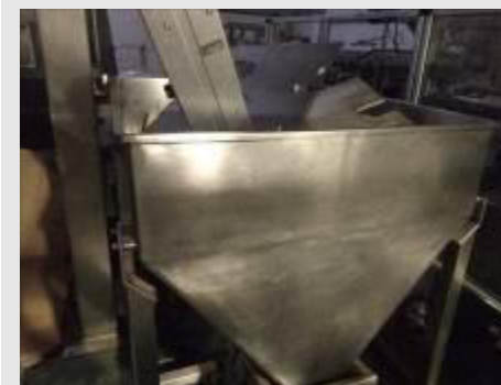
SISTEMA DE DOSAGEM E ALIMENTAÇÃO DA BALANÇA | Item: 46 |
