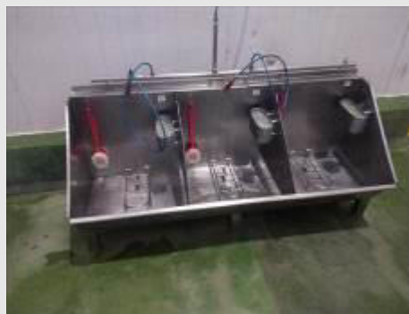
LAVADORA TRIPLA MANUAL DE BOTAS EM AÇO INOX, C/ 2 BICOS DE DUCHA | Item: 1 |
