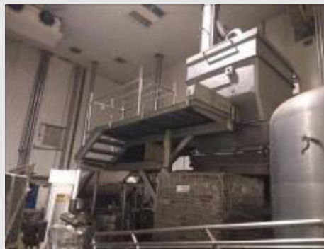
LINHA DE PREPARAÇÃO DE MOLHO POUCH EM AÇO INOX, COMPOSTO POR TANQUE COZINHADOR, TOSTADOR E SECADOR | Item: 91 |
