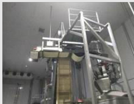
ESTEIRA TRANSPORTADORA EM AÇO INOX, MOD. SUPERIOR, P/ COLETA DE EMBALAGEM 25GR | Item: 34 |
