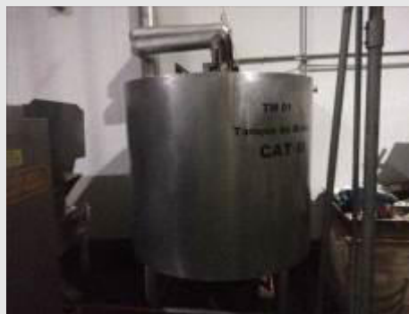
TANQUE CILINDRICO VERTICAL EM AÇO INOX, DIAM. 1.250X1.400 MM, C/ SISTEMA DE AGITAÇÃO E SERPENTINA DE RESFRIAMENTO | Item: 92 |
