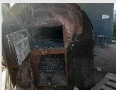
FORNALHA A LENHA DIM.2,10X2,00X4,00M | Item: 50 |
