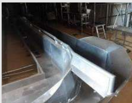
CANAleta EM AÇO INOX PARA SANGRIA DIM.400X2400MM | Item: 5 |
