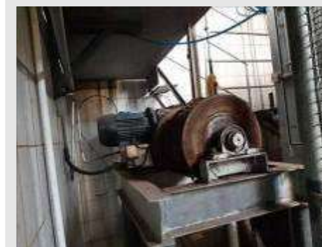
GUINCHO ELÉTRICO PARA BOI ACIDENTADO CAP.2000KG | Item: 20 |
