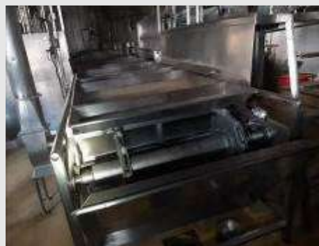
MESA EM AÇO INOX AUTOMÁTICA PARA EVISCERAÇÃO DIM.1400X12000MM COM 32 BANDEIJAS | Item: 12 |
