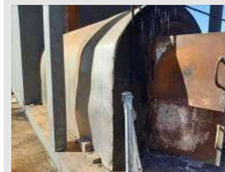
FORNALHA A LENHA DIM.2,10X2,00X4,00M | Item: 50 |
