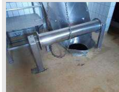
ROLETE EM AÇO INOX PARA COURO DIAM.220X1200MM | Item: 14 |
