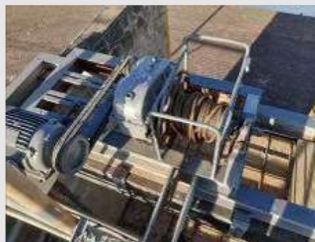
GUINCHO ELÉTRICO PARA ARRASTE DE BOVINOS DEITADOS CAP.2000KG | Item: 37 |
