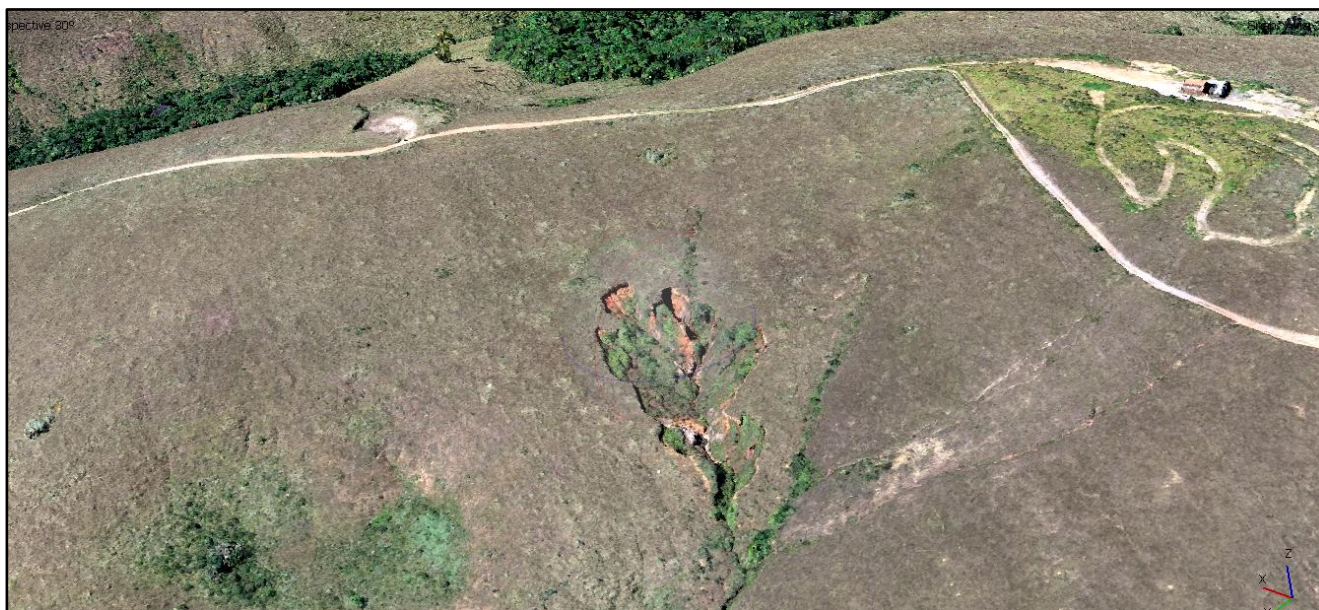
Figura 22: Vista 3D do terreno gerada pelo aerolevantamento, zoom na área com erosão no vale na face do Córrego do Codorna.
