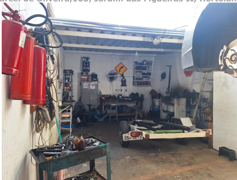
Imagem 29 – Vista Interna – OFICINA MECÂNICA. Vista para depósito de materiais e ferramentas da oficina. Parede em alvenaria / reboco / pintura. Piso cimentado. Cobertura metálica. Acesso franqueado pelo Executado.
