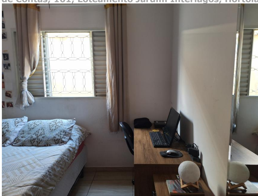
Imagem 55 – Vista Interna – SUÍTE. Paredes em alvenaria / reboco / pintura. Piso com revestimento cerâmico. Esquadria em madeira e alumínio.
