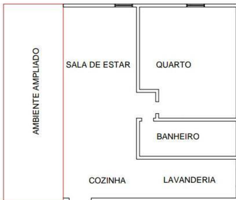
Figura 1: Croqui de situação do apartamento, o perímetro em cor vermelha representa a expansão para o ambiente do imóvel vizinho.
